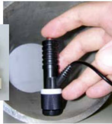
●パイプ内壁や狭い空間の硬さ試験
