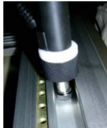
●隙間や溝、浅い段差部分の硬さ試験
