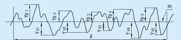
$R_z = \frac{ Y_{p1} + Y_{p2} + Y_{p3} + Y_{p4} + Y_{p5}  +  Y_{v1} + Y_{v2} + Y_{v3} + Y_{v4} + Y_{v5} }{5}$ <p>Y<sub>p1</sub>、Y<sub>p2</sub>、Y<sub>p3</sub>、Y<sub>p4</sub>、Y<sub>p5</sub> : 基準長さ<math>\ell</math>に対する抜取り部分の、最も高い山頂から5番目までの山頂の標高<br/>Y<sub>v1</sub>、Y<sub>v2</sub>、Y<sub>v3</sub>、Y<sub>v4</sub>、Y<sub>v5</sub> : 基準長さ<math>\ell</math>に対する抜取り部分の、最も低い谷底から5番目までの谷底の標高</p> |
